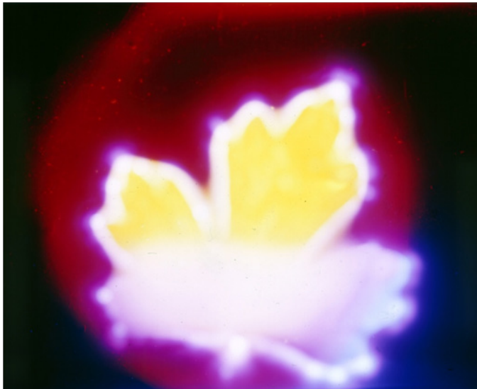
Kuva 26. Kuvausjärjestely B, 2 mm lasi filmin ja kohteen välissä.
